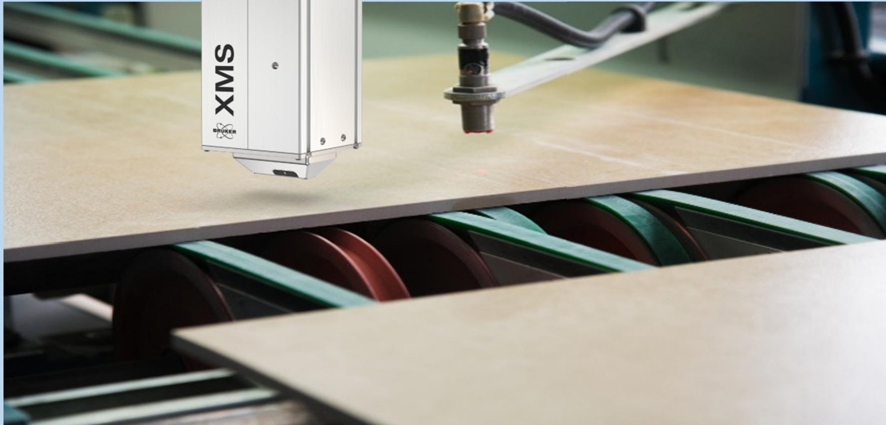
**AUTOMATED X RAY FLUORESCENCE MEASUREMENT SYSTEM**
