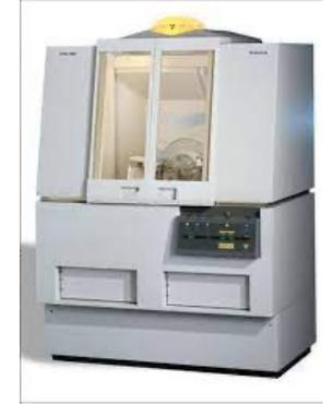
Diffrazione dei raggi X → Identificazione delle fasi cristalline
